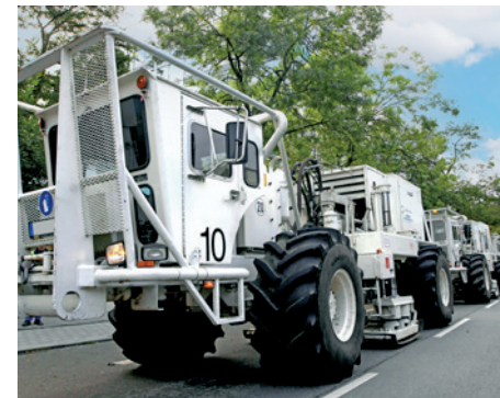
Im Rahmen des Verfahrens der 3D-Vibro-seismik kommen auch sogenannte Vibrotruck-Fahrzeuge zum Einsatz.
